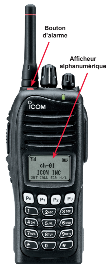
▲ Portatif radio présenté avec antenne courte (option)
